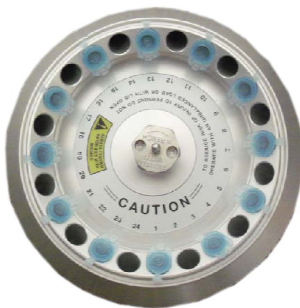
Figura 1. Carregar o rotor de forma a obter equilíbrio
