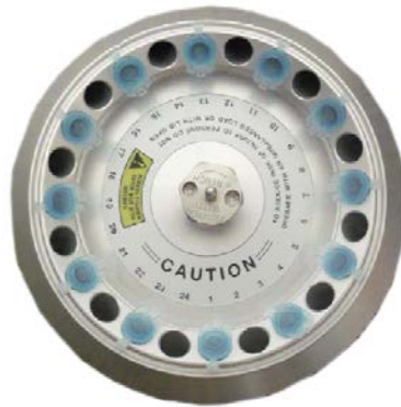
Abbildung 1. Ausgeglichenes Beladen des Rotors
